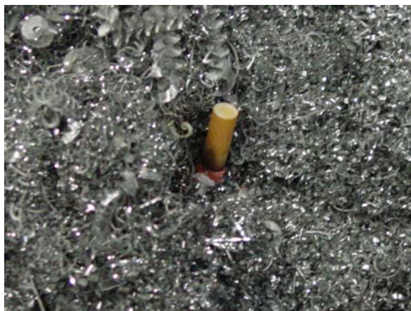
Bild 6: Zündquellen im Spänebehälter [6]
