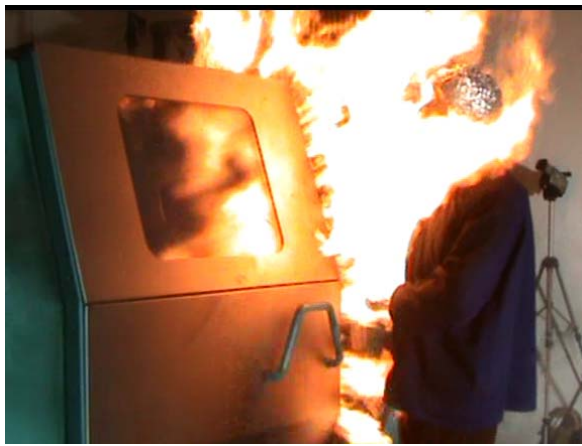
Bild 6: Flammenaustritt aus offenem Türspalt (6 cm) bei einer Verpuffung (Dummy)
