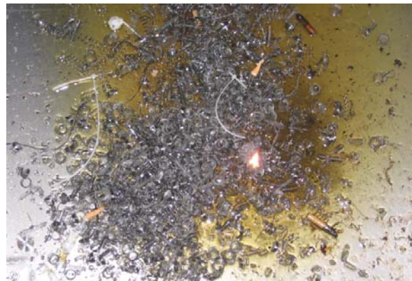
Bild 5: Zündquellen Zigarettenkippen, Brand im Spänebehälter
